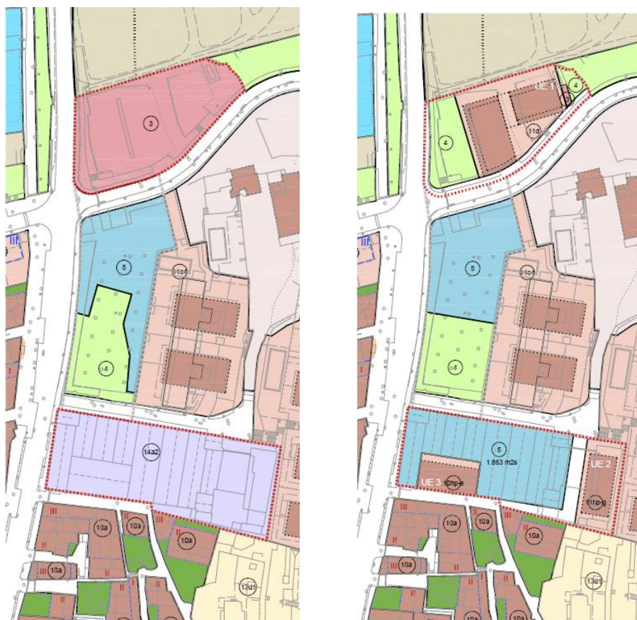
Figura 3.2. Comparativa entre l'ordenació vigent (esquerra) i la proposta de nova ordenació (dreta). La línia discontinua de punts delimita l'àmbit de la MPPUOM i els dos polígons amb perímetre discontinu vermell identifiquen l'àmbit específic del PAU-20.
